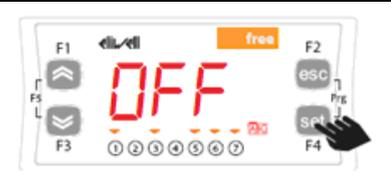
Чтобы отключить дифференциальную функцию и перейти к фиксированной настройке задайте значение как “OFF - выкл”. Чтобы вернуться к функции дифференциальной уставки установите данное значение как “ON - вкл”.
