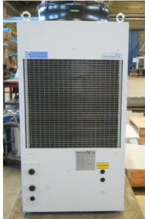
Abbildung 23 – Position des Luftfilters
