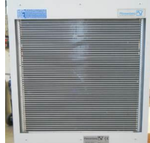
Abbildung 24 – Außenoberfläche des Kondensators
