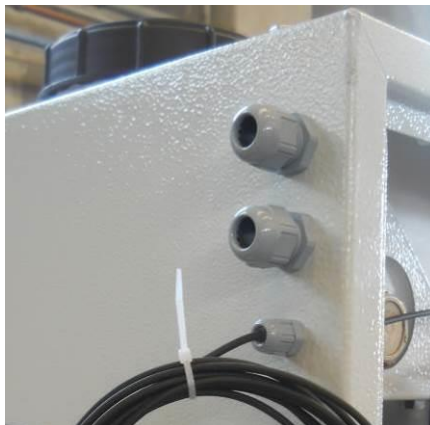
Figure 5 – Plaque pour les raccordements électriques
