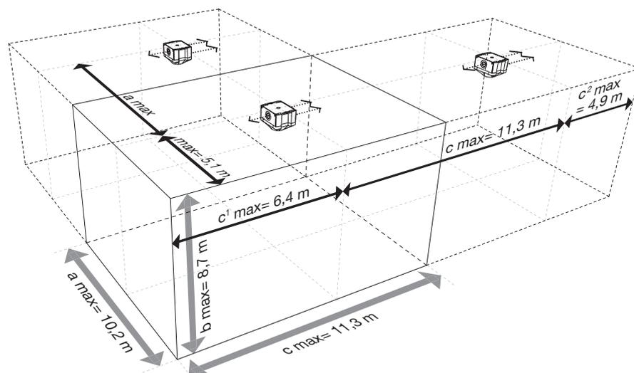
Signalisierungsreichweiten der PYRA Blitzleuchte PY X-S, 24 V DC, klare Haube, am Beispiel einer **Deckenmontage**.
