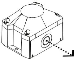
An der Seite mit **einem** Kabelausbruch beträgt die Reichweite 3,5 m.
