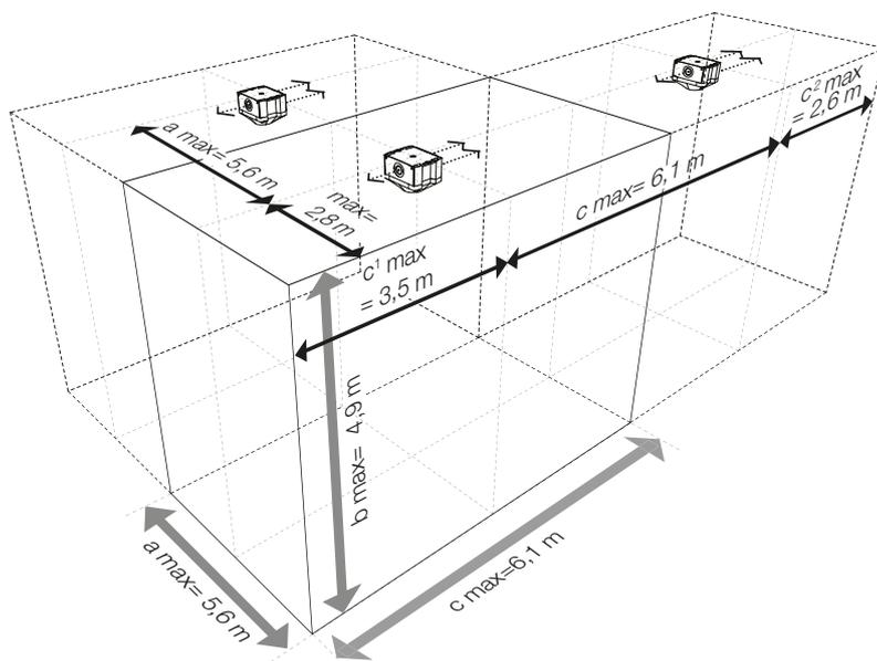
Signalisierungsreichweiten der PYRA Blitzleuchte PY X-S, 24 V DC, rote Haube, am Beispiel einer **Deckenmontage**.
