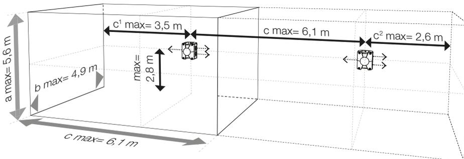
Signalisierungsreichweiten der PYRA Blitzleuchte PY X-S, 24 V DC, rote Haube, am Beispiel einer **Wandmontage**.
