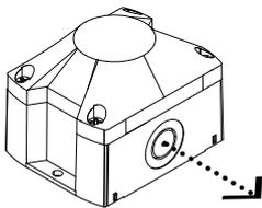
An der Seite mit **einem** Kabelausbruch beträgt die Reichweite 6,4 m.
