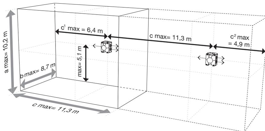
Signalisierungsreichweiten der PYRA Blitzleuchte PY X-S, 24 V DC, klare Haube, am Beispiel einer **Wandmontage**.
